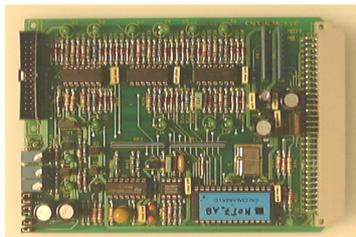
Questa è una scheda logica disegnata per controllare le funzioni operative della scheda MOT7, sia in maniera automatica sia mediante comandi inviati dal processore principale della scheda MOT5.
