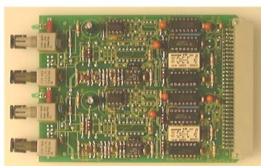
Questa scheda è equipaggiata con due paia di trasduttori optoelettronici per attuare la funzione di trasmissione e ricezione delle fibre ottiche di ogni lato dell'anello.
