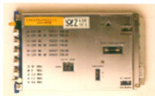
Scheda video, inserita nel bus 80, tanto nelle stocentrali UZM che nella centrale principale. La scheda permette l'interfacciamento di una telecamera a colori CCD o di un monitor a colori alla linea bifilare di trasmissione inserita nell'anello principale. In ciascuna scheda vengono effettuate le operazioni di decompressione ed equalizzazione del
