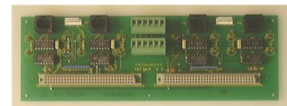
La scheda è disegnata per controllare la sezione di segnale degli anelli (linea seriale o linea CCTV) nella centrale principale HZ per la versione del sistema a fibre ottiche. La scheda è disegnata per ospitare due schede interfaccia ottiche MOT18FO, una per l'anello principali e l'altra per l'anello seriale ausiliario (UZK).
