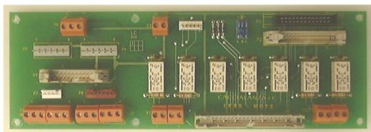
Scheda per il controllo dell'anello, sezione di segnale (linea seriale e linea TVCC) in tutte le versioni del sistema con cavo in rame. La scheda permette il sezionamento in ingresso e in uscita della linea seriale, con richiusura dell'anello risultante mantenendo inserita in ogni caso la diramazione alla
