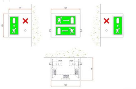
L'innovativo sistema proposto consente di visualizzare lungo l'intero sviluppo della galleria la via di fuga relativa alla condizione di emergenza esistente, con una indicazione ottica continua e univoca che rimane visibile e seguibile senza soluzione di continuità anche in presenza di fumo.
