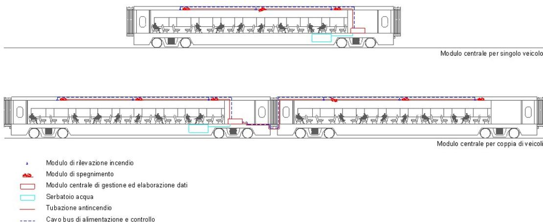
Il sistema di spegnimento VES (Vehicle Extinguishing System) è concepito per essere montato su veicoli e unità mobili ed è in grado di funzionare in maniera completamente autonoma e automatica.
