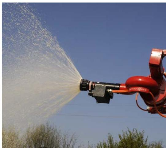
L'irrorazione dell'area avviene con getto nebulizzato a bassa pressione, in maniera di escludere anche qualunque rischio di danno alle persone per azione fisica dinamica del getto. La provvista di estinguente trasportata a bordo garantisce un intervento di spegnimento di almeno 15 minuti.
