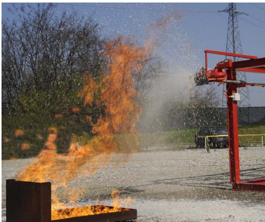
I monitori miniaturizzati, che realizzano la loro funzione di spegnimento spruzzando una miscela contenente schiumogeno antincendio, lavorano a una pressione ridotta e sono in grado di irrorare nel tempo tutta la cubatura del veicolo.
