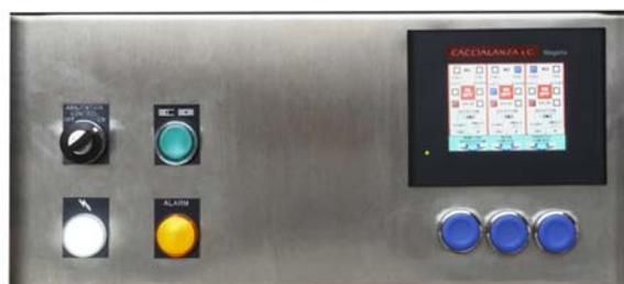
L'intervento manuale di primo livello è attuabile tramite una interfaccia grafica a colori che si trova incorporata nel modulo stesso ed è essenzialmente previsto per operazioni di controllo e di manutenzione. In ogni caso l'interfaccia del modulo permette all'operatore di effettuare tutte le manovre operative senza limitazioni.
